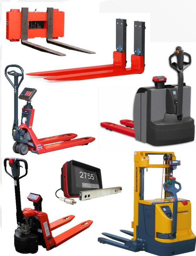
Системы мобильного взвешивания **RAVAS** – это весы, интегрированные в транспортное оборудование – погрузчики, штабелеры, коммиссионеры, ричтраки или ручные тележки.
